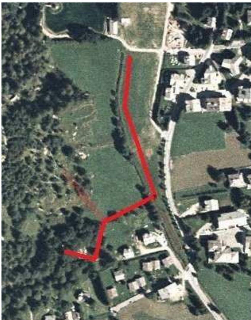
1. Posa condotta in tubi di acciaio per complessivi **351 metri**, per fornitura dell'acqua posati a una profondità minima di 100 cm a un max di 150 cm posati con livellette in pendenza senza risacche fra un pozzetto e l'altro per ottenere uno scarico completo della nei periodi di non utilizzo.
