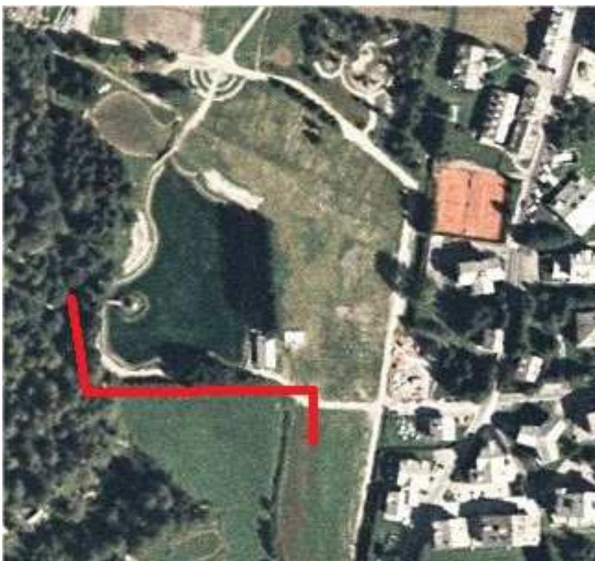
1. Posa condotta in tubi di acciaio per complessivi **194 metri**, per fornitura dell'acqua posati a una profondità minima di 100 cm a un max di 150 cm posati con livellette in pendenza senza risacche fra un pozzetto e l'altro per ottenere uno scarico completo della nei periodi di non utilizzo.
