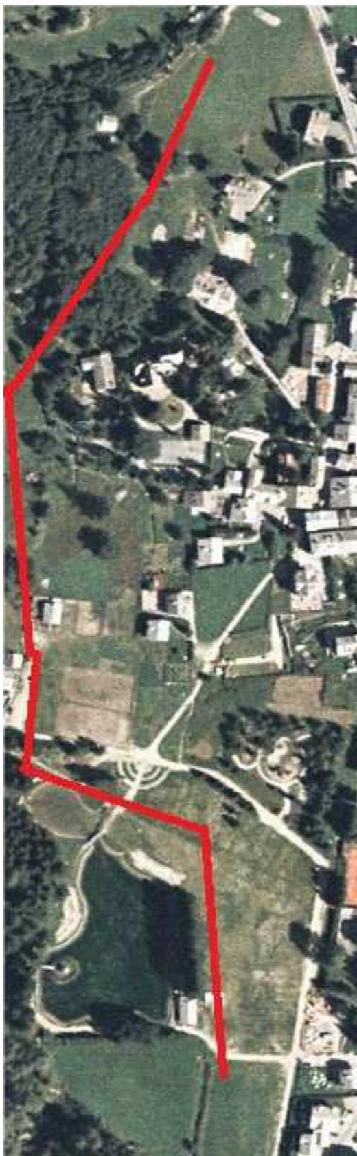
1. Posa condotta in tubi di acciaio per complessivi **792 metri**, per fornitura dell'acqua posati a una profondità minima di 100 cm a un max di 150 cm posati con livellette in pendenza senza risacche fra un pozzetto e l'altro per ottenere uno scarico completo della nei periodi di non utilizzo.
