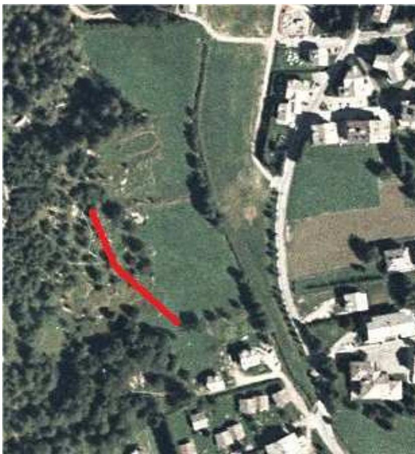
1. Posa condotta in tubi di acciaio per complessivi **102 metri**, per fornitura dell'acqua posati a una profondità minima di 100 cm a un max di 150 cm posati con livellette in pendenza senza risacche fra un pozzetto e l'altro per ottenere uno scarico completo della nei periodi di non utilizzo.
